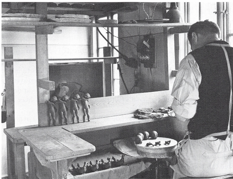
Figurerens enkelte dele samles med lervælling inden brændingen. Der går mange dele til en hel figur. Fotografi fra 1943.
