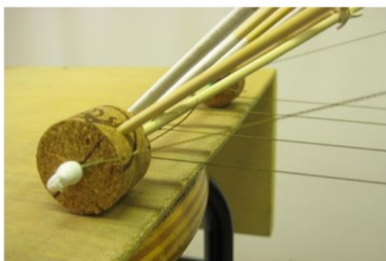
5-6. Tipologia di ponte ad arco e relativo dettaglio dell'appoggio, realizzato sfruttando tappi di sughero
