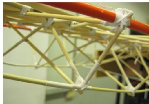
8-9. Tipologia di ponte-trave armata e relativo dettaglio del collegamento tra aste, realizzato con teflon (bianco) e nastro termorestringente (arancione)
