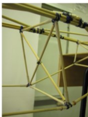
10-11. Tipologia di ponte-trave armata e relativi dettagli costruttivi (controventamenti verticali e orizzontali)
