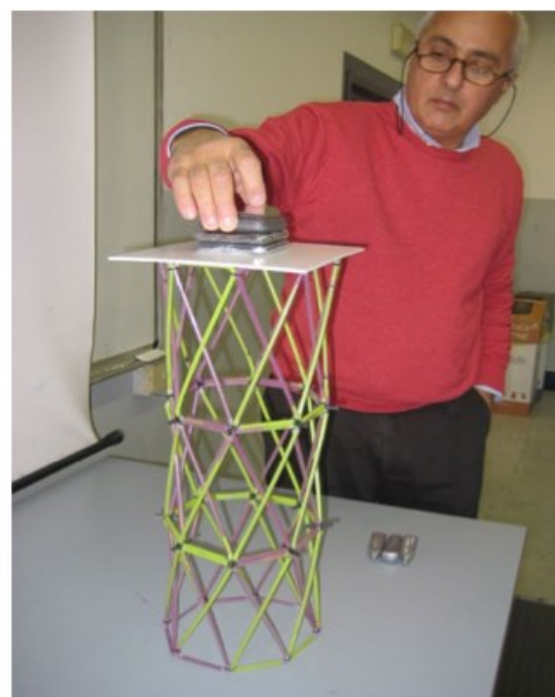
3-4 Esercitazione con cilindri realizzati con cannucce da bibita, prima e durante la fase di verifica (caricati con lingotti di piombo)
