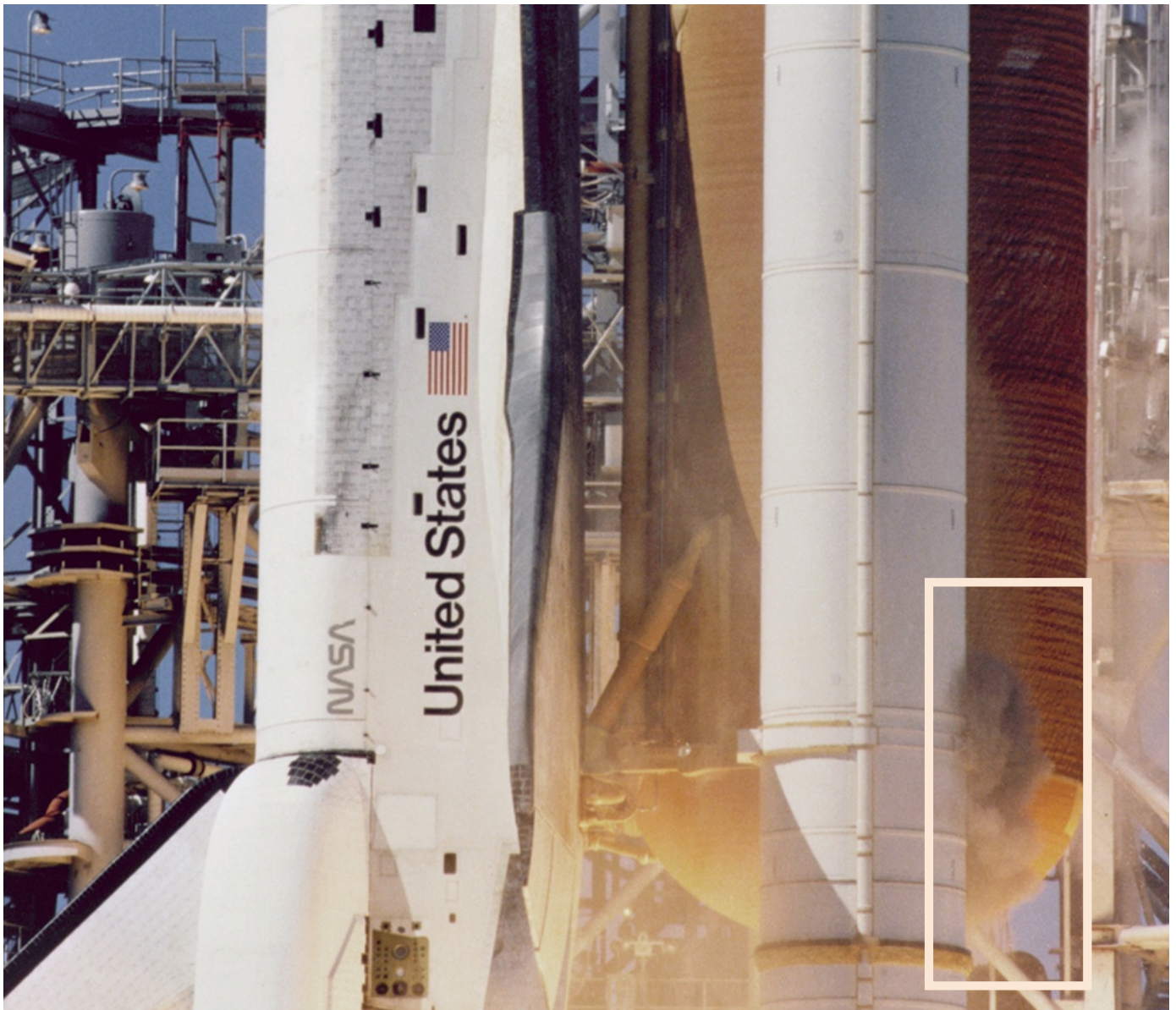
Des bouffées de fumée noire s'échappent quelques secondes du booster au décollage de Challenger.
