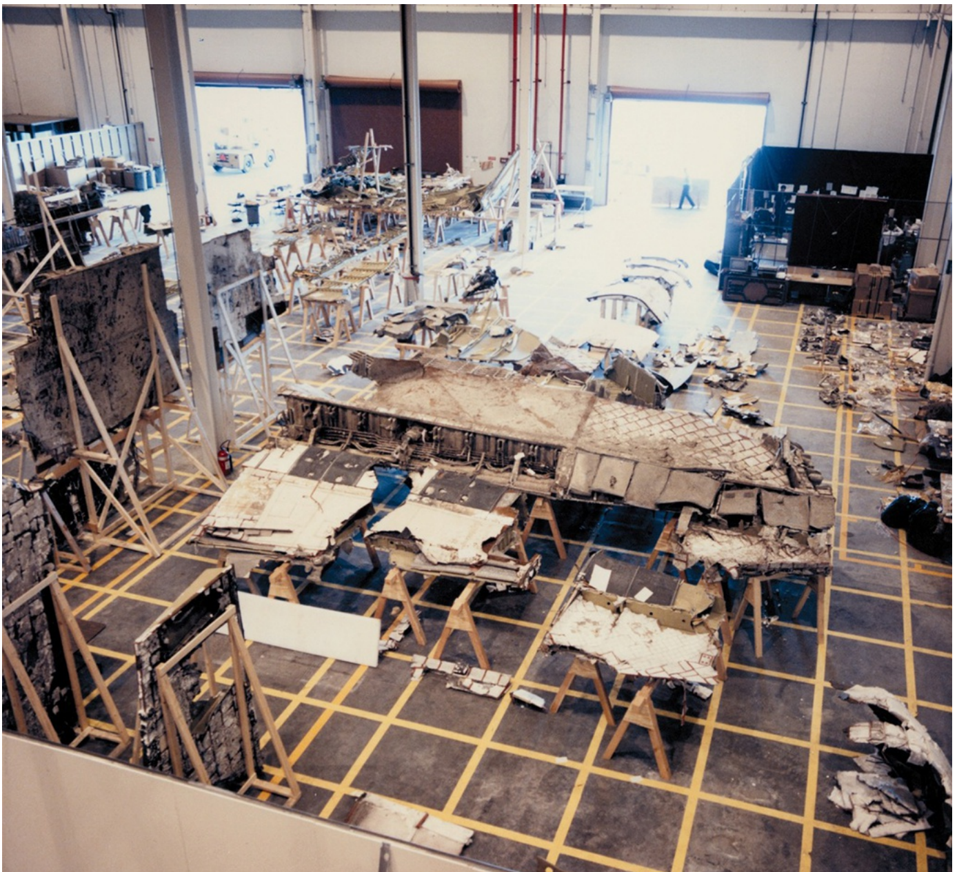
La zone d'entreposage temporaire de l'épave de la navette Challenger avec ici une vue sur les débris de l'aile droite.
