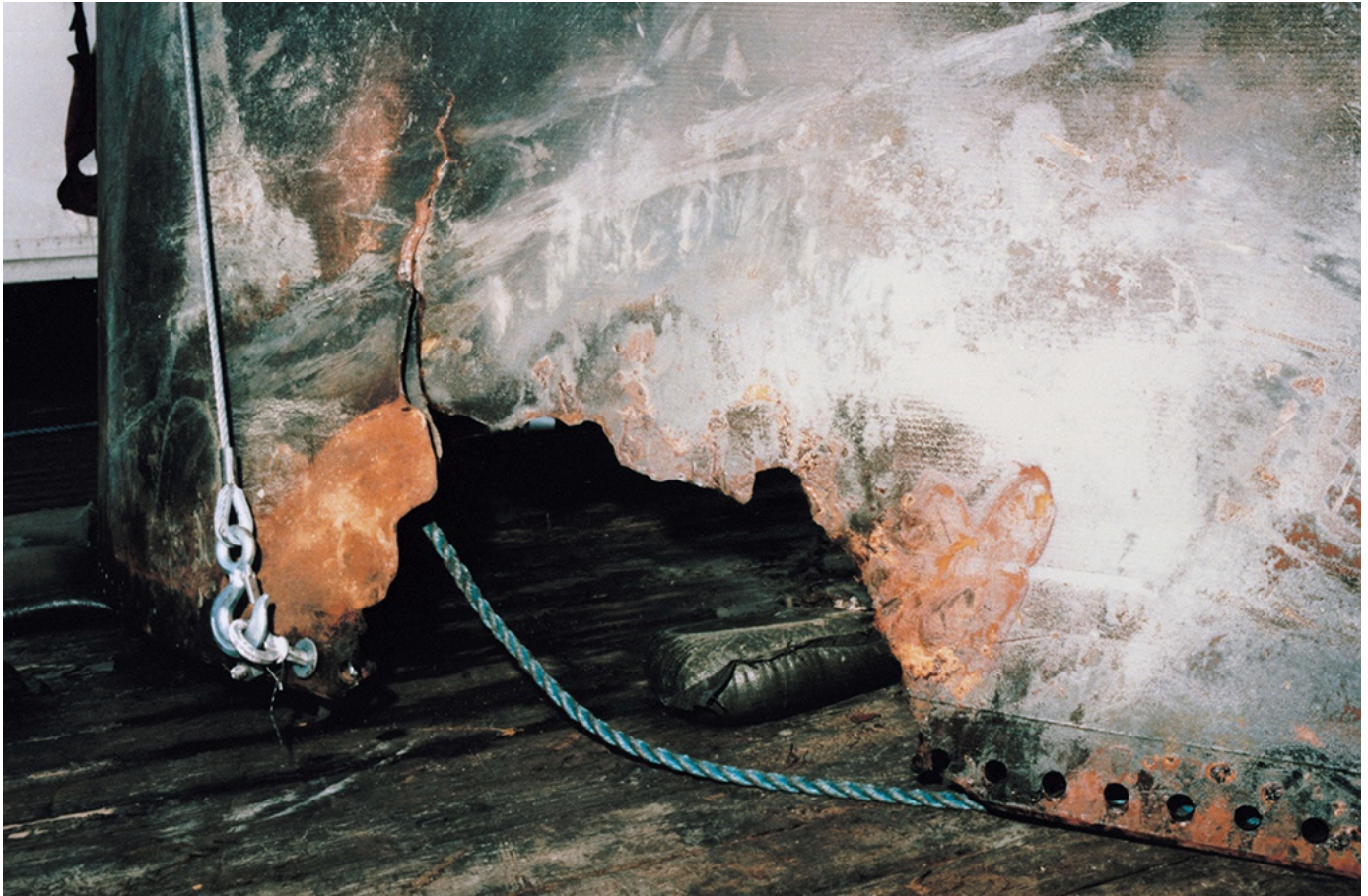
La pièce « Contact #131 » constitue la preuve matérielle de la défaillance de Challenger. Provenant d'une section précise du booster droit, elle présente une perforation caractéristique là où les flammes ont transpercé les joints toriques.
