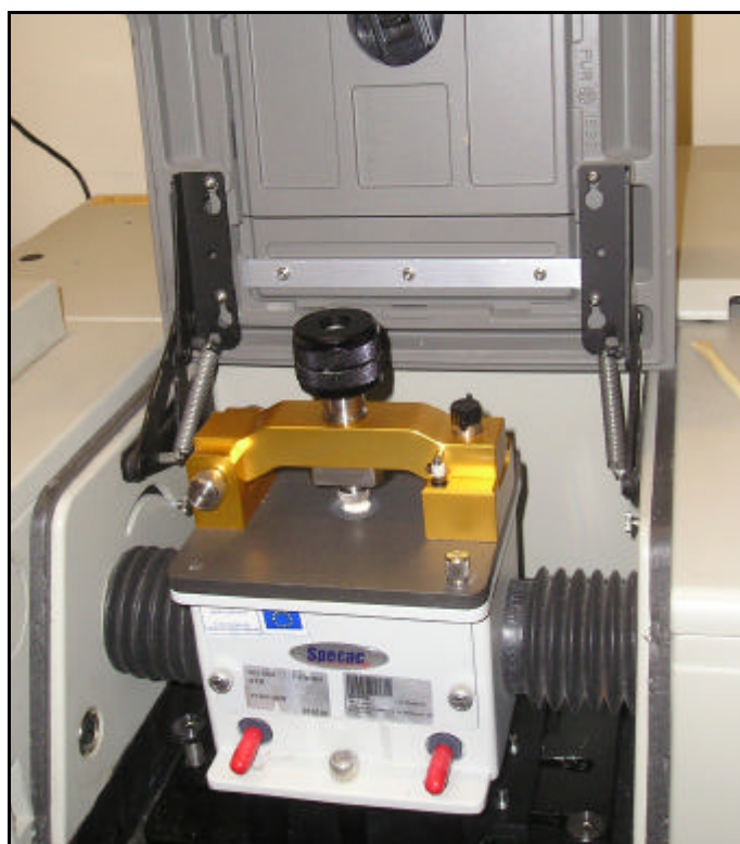
Fig. 15. Espectrómetro FT-IR utilizado para analizar cambios químicos en tejidos de olmo.
