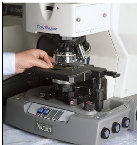
Fig. 14. Microscopio acoplado a un espectrómetro FT-IR, para analizar químicamente secciones transversales de ramillos de Ulmus minor .
