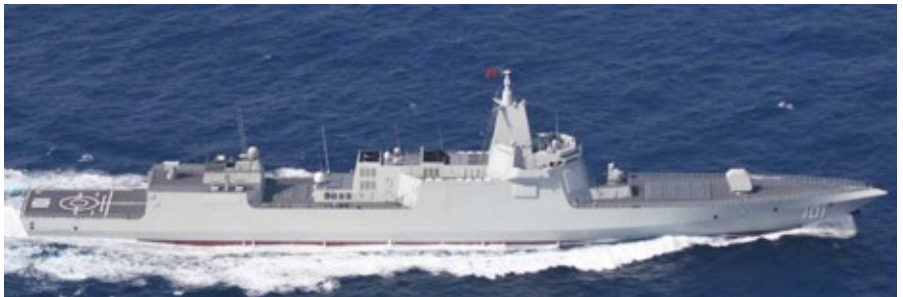
Destroyer chinois type 055 Nanchang entré en service en janvier 2020 180 mètres de long, déplacement de 12000 tonnes. ©mod.go.jp
