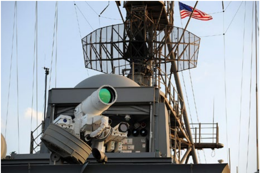
Système d'armes laser embarqué à bord de l'USS Ponce. ©US Navy
