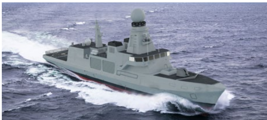
La future corvette européenne ( European patrol corvette ) : 110 mètres de long, déplacement de 3000 tonnes. ©Wikipédia/Rama
