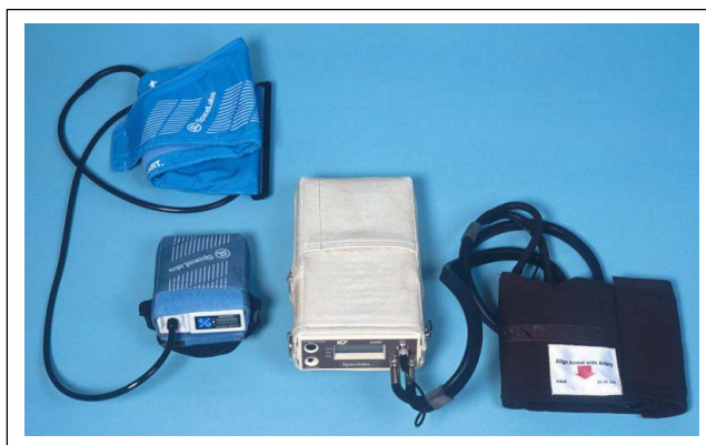
Abbildung 5: Portable Langzeitblutdruckmeßgeräte: Rechts: auskultatorische Gerät, halbautomatisch, Meßvorgang muß vom Patienten per Knopfdruck gestartet werden. Links: vollautomatisch oszillometrisch messendes Gerät.
