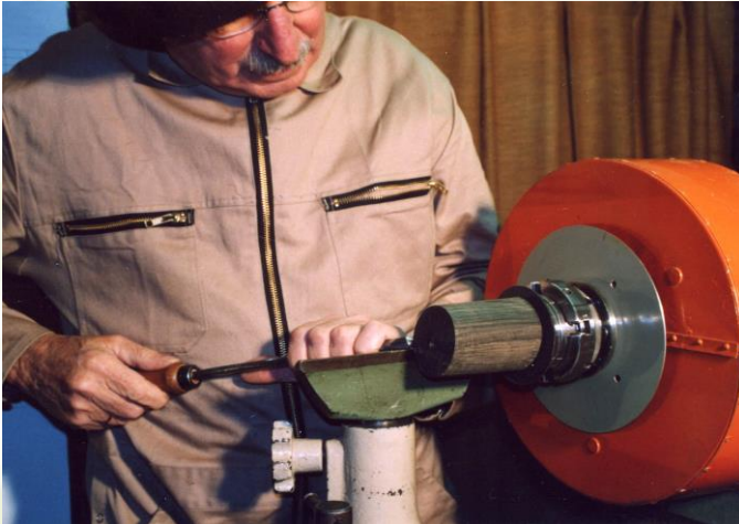
Bild 5601 Dose aus Langholz im VICMARC-Vierbackenfutter VM90 an der ODM30
