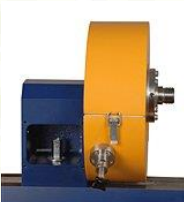
Bild 3407 Spindelstock der Steinert® Ovaldrehmaschine picOval, ohne Antrieb, aufsetzbar auf jede geeignete Drehbank und anpassbar an jede Spindelhöhe mittels Adapterplatte [5.4]
