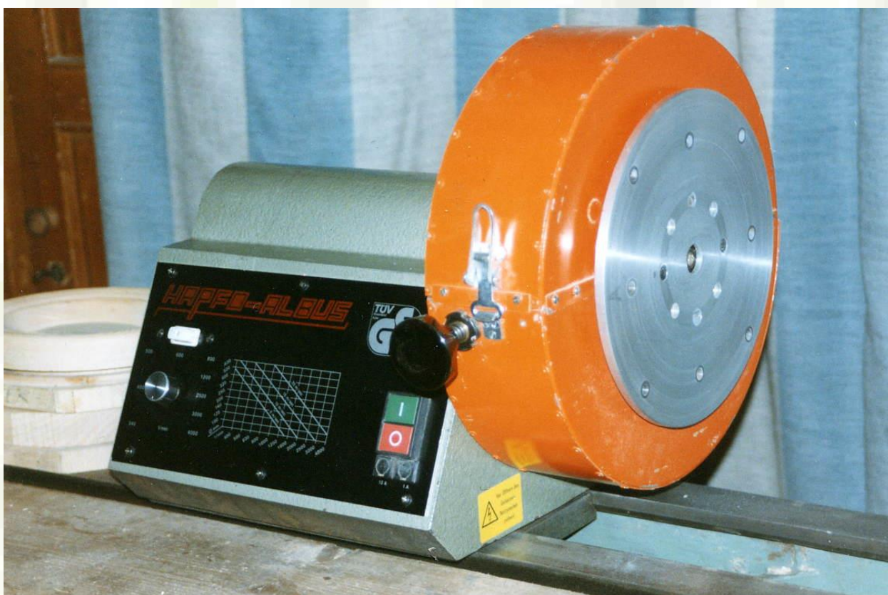
Bild 3403 Ovaldrehmaschine ODM30 (Werkstatt J. Volmer, Chemnitz 1993)
