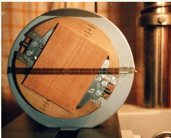
Bild 5405 Anzeichnen der das Profil begrenzenden Ellipsen
