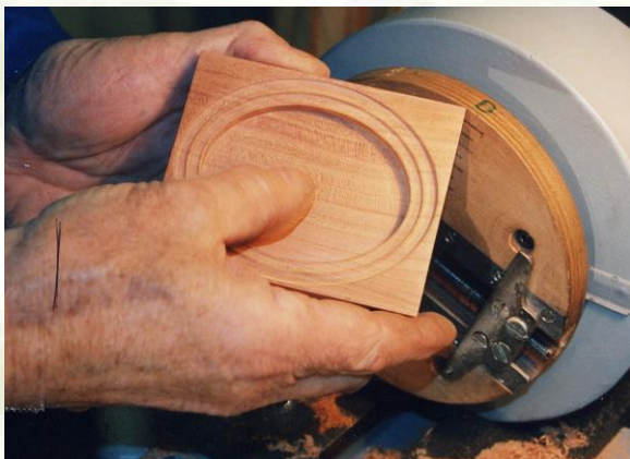
Bild 5408 Schleifen des Profils nahe der Zentrallinie
