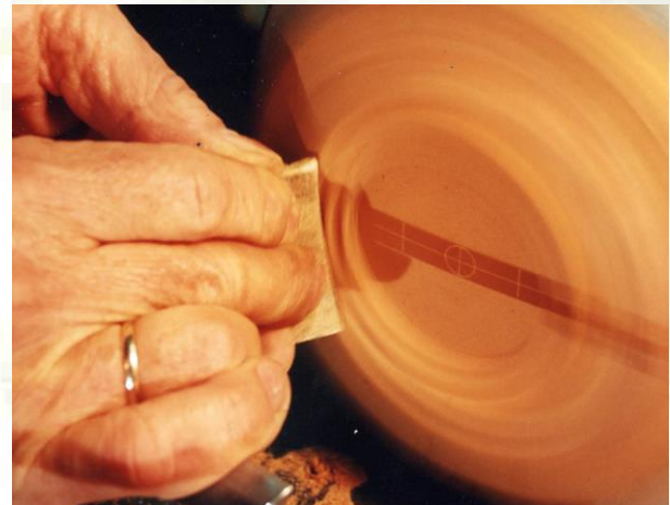
Bild 5408 Schleifen des Profils nahe der Zentrallinie
