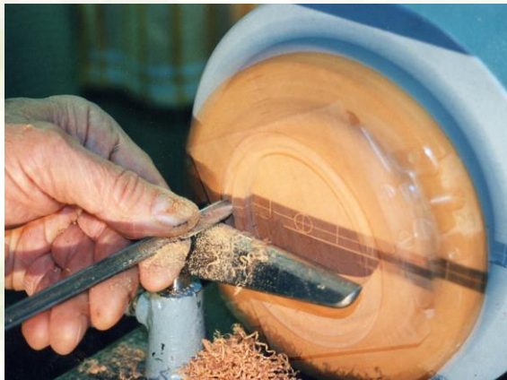
Bild 5408 Schleifen des Profils nahe der Zentrallinie
