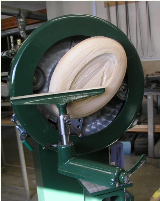
Bild 3405 Bollinger Ovalturning Lathe (BOTULA) [5.3]
