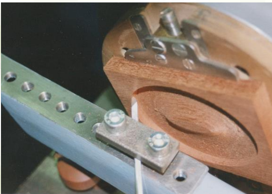
Bild 5205 Nach Ausdrehen des Falzes von Hand bis auf einen oder zwei Millimeter wird mit dem Stecher die Wand des Falzes fein fertig gedreht.
