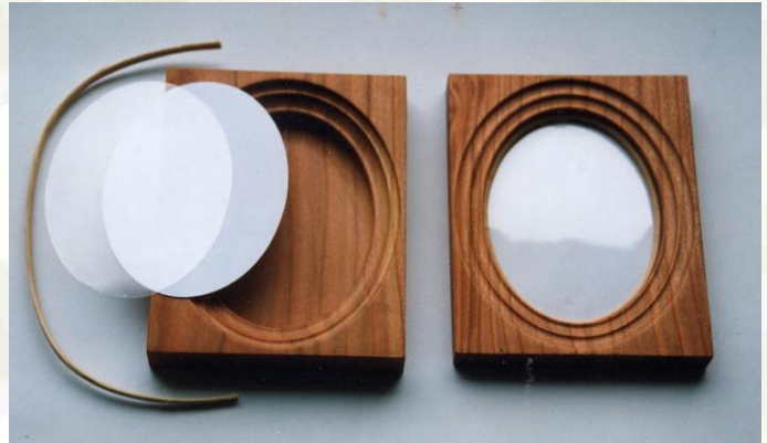
Bild 5411 Glas (Folie) und Einlage mit Rattan-Klemmring, rechts eingespreizt
