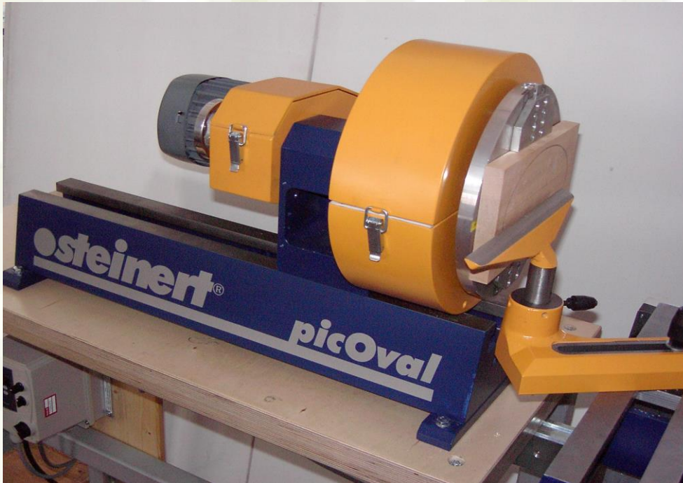
Bild 3406 Ovaldrehmaschine picOval (Drechselzentrum Erzgebirge Steinert®, 2006 [5.4] )
