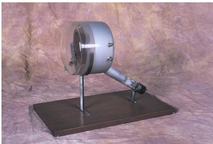
Iconoscope incorporé aux premières caméras de télévision commerciales en Amérique du Nord, vers 1940
