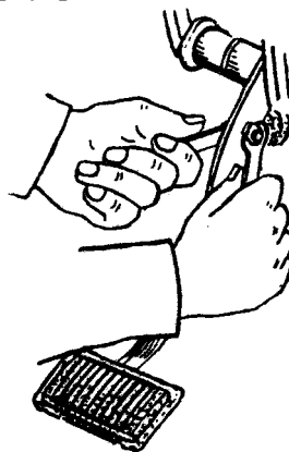
Рис. 72. Регулировка свободного хода тормозной педали.
