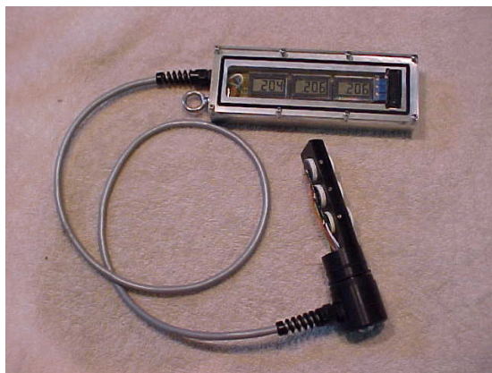
Batería de tres sensores de O_2 y tres displays independientes.
