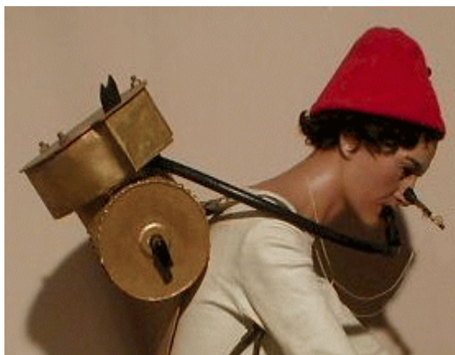
El primer rebreather, el prototipo de Rouquayrol y Denayrouze de 1860
