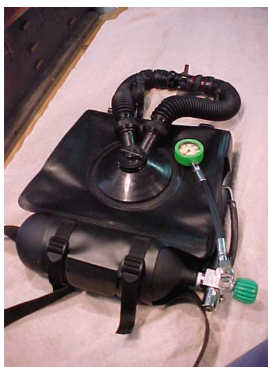
Un OMG C-96, un rebreather de O 2 compacto y de calidad.
