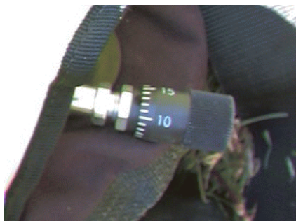
Válvula de aguja ajustable para una inyección de gas a masa constante desde una primera etapa no compensada con la profundidad.
