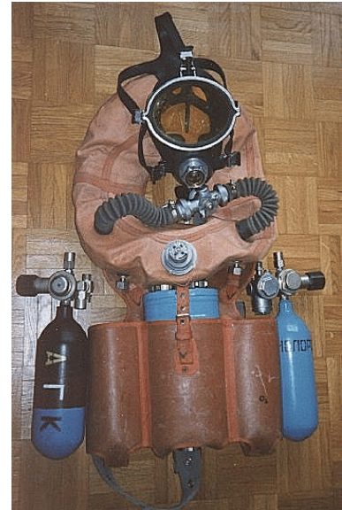
El IDA 59 soviético, originariamente un sistema de escape desde submarinos es un rebreather mezclador totalmente manual.
