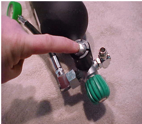
Detalle de la válvula manual de un ARO OMG C-96.
