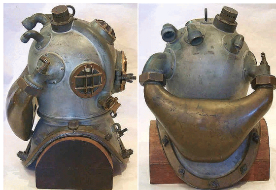
Un DESCO MKV mod 1 habilitado para buceo profundo con un sistema de recirculación de heliox. (modelo conocido como china hat )
