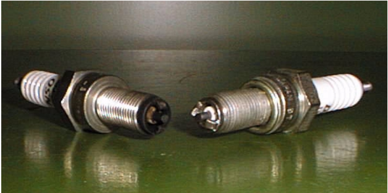
Bild 6.6.9: Zündkerze eines Wankel-Vielstoffmotors
