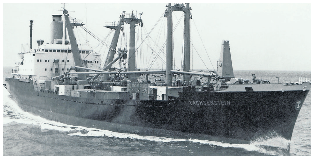
Nach dem Umbau der SACHSENSTEIN sind die umfangreiche Ausrüstung und die provisorische Unterbringung der Container gut erkennbar. (Foto: Gerhard Fiebigler/NDL)
