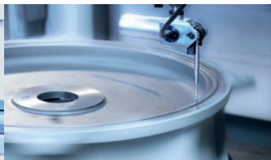
Koaxialitätsmessung am Formmeßplatz
