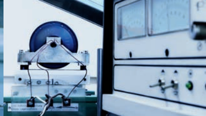
Auswuchtung des Kreiselhauptmotors
