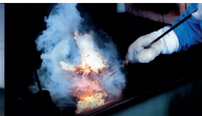
Anlassen der gehärteten Schneiden und Pfannen
