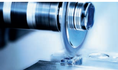
Fräsen von Nuten in Schneiden
